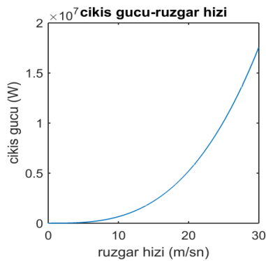
Şekil 1: Rüzgâr hızı-rüzgâr gücü eğrisi.
