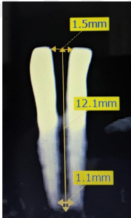
Şekil 2.20 Tomografik ölçümlerin yapılması (D =1.5 mm d =1.1 mm L =12.1 mm)
