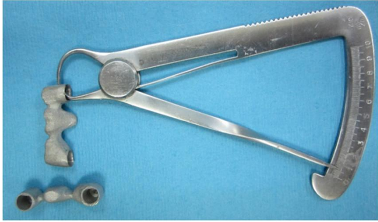
Şekil 2.5 Metal alt yapıların kalınlık kontrolü
