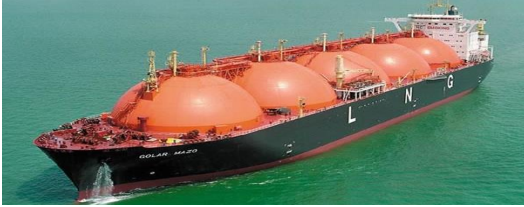
Şekil 2: LNG Taşımacılığında Kullanılan Özel Tanker Gemiler.
