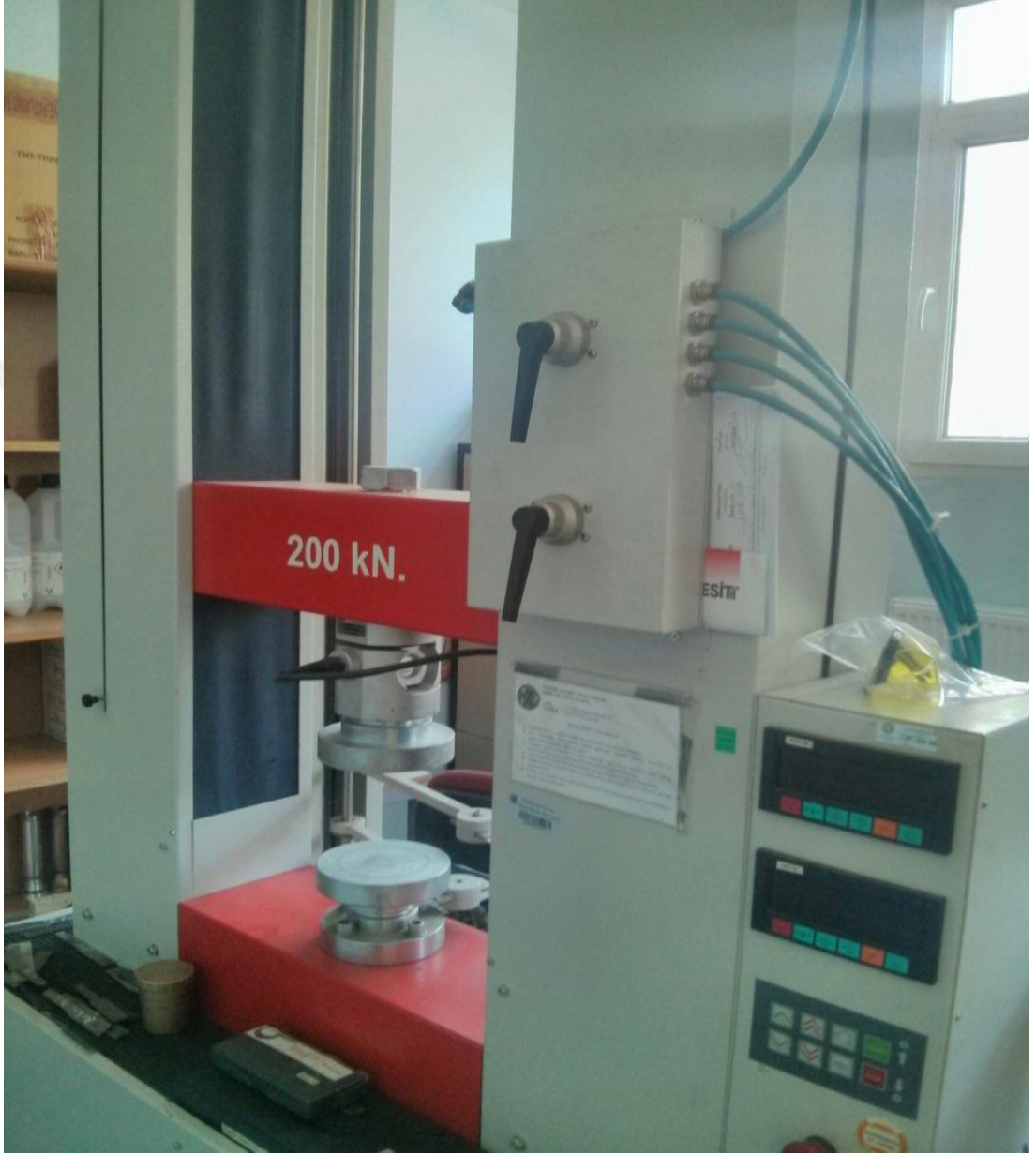
Şekil 3.4. Kalitest KT/ 2010-001 seri numaralı çekme test cihazı
