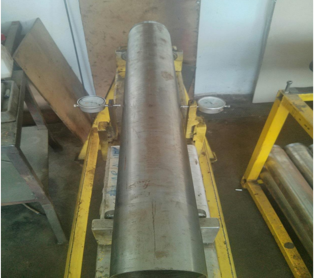
Şekil 3.6. Hidrostatik test öncesi ve sonrası deformasyon kontrol aparatı
