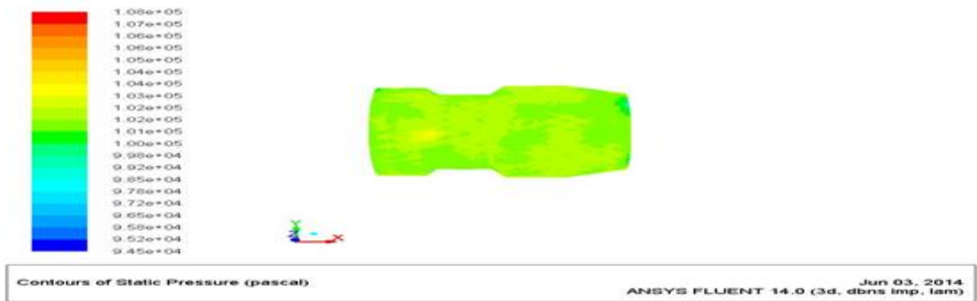
Şekil 7.6. 20,000 ft irtifada turbojet motorun statik basınç konturü
