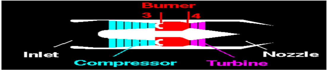
Şekil 4.1. Turbojet motor yanma termodinamiği şeması [62]
