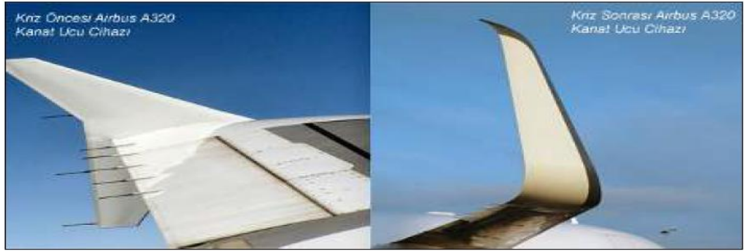
řekil 3.27. Airbus A320’lerde kullanılan eski ve yeni tip kanat ucu cihazları [58]
