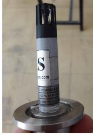
Şekil 3.5. Nem ve sıcaklık ölçer flanş bağlantısı
