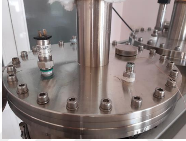
Şekil 3.10. Adsorbent yatak üst kapak (sıcaklık- basınç ölçüm)
