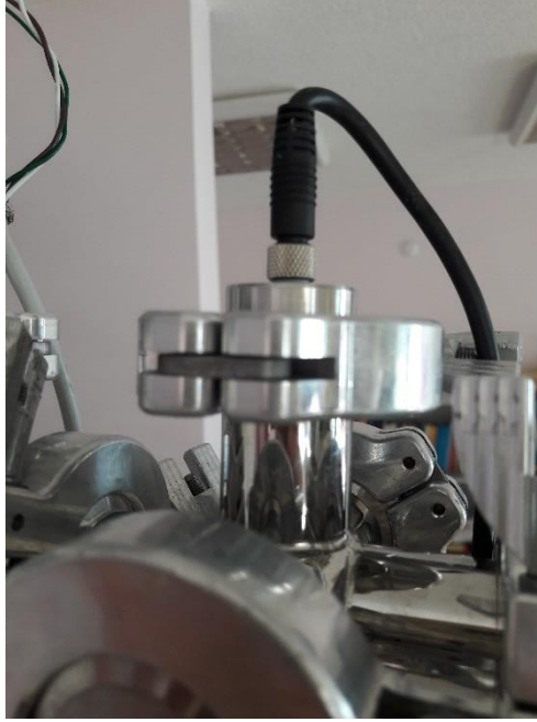
Şekil 3.17. Nem ve sıcaklık sensörü montajı
