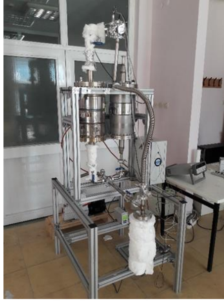
Şekil 3.30. Adsorpsiyonlu soğutma sistemi deney düzeneği
