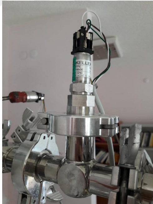
Şekil 3.19. Basınç sensörü montajı
