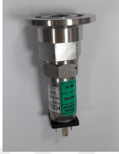
Şekil 3.4. Basınç sensörü flanş bağlantısı
