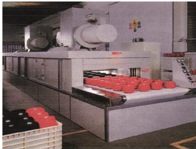
Şekil 2.6. Taşıma bantlı radyofrekanslı kurutma makinesi [4]
