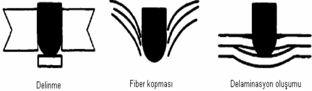
Şekil 2.13. Delinme, fiber kopması ve delaminasyon oluşumunun genel görünüşü
