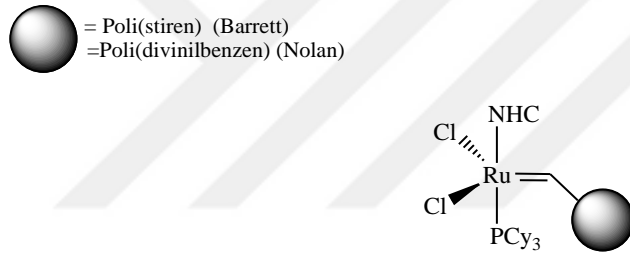
Şekil 1.16. Alkiliden değişimi ile desteklenen ikinci nesil Grubbs katalizörü.
