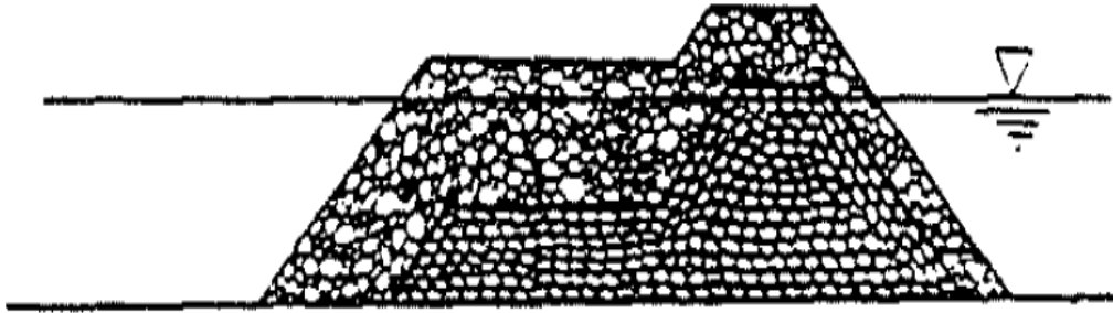
Şekil 2.6. Şekillenebilen taş dolgu dalgakıran kesiti (Takahashi, 1996)
