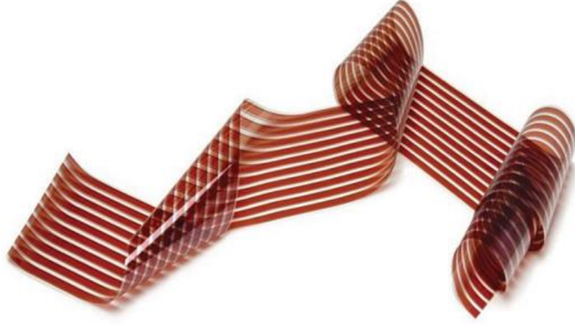
Şekil 2.7. Organik güneş pillerinin esneklikleri. Eğrilebilir ve yuvarlanabilirler [6].
