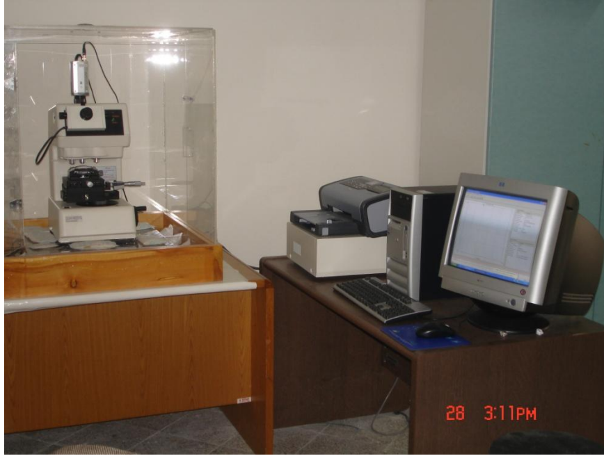
Şekil 2. 10. Dinamik ultra mikrosertlik test cihazı (Shimadzu, DUH-W201)
