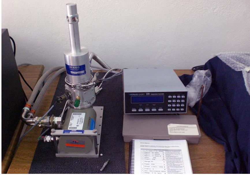
Şekil 2. 8. Özdirenç ölçümlerinin yapıldığı Cryogenic marka sıvı helyum kriyostat sisteminin fotoğrafı
