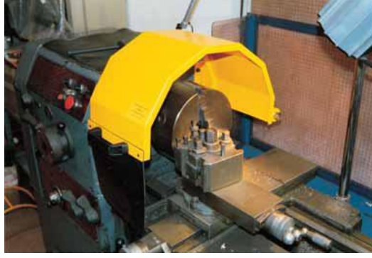
Şekil 5.1 Torna Tezgâhının Ayna Bölgesindeki Muhafaza
