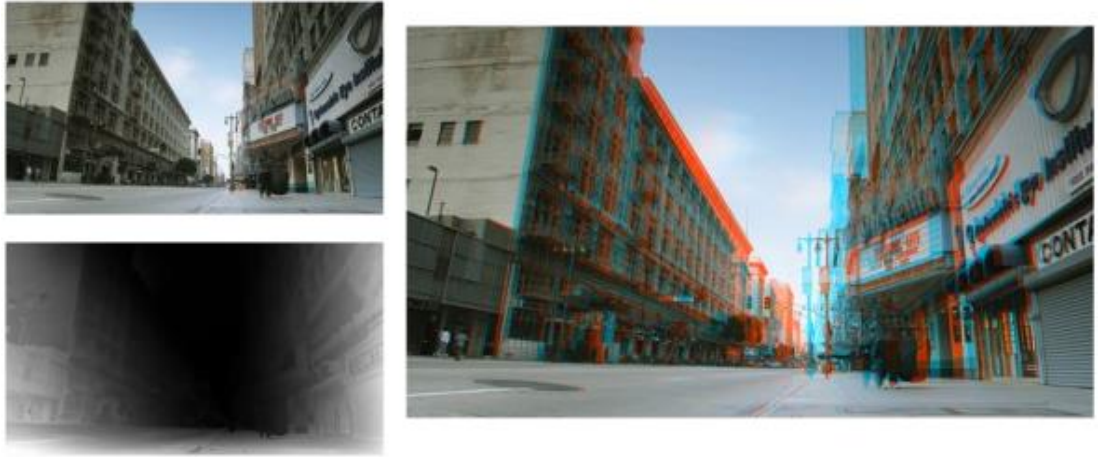
Şekil 1.8. 2B video ve DH ile 3B video oluşturulması [28]
