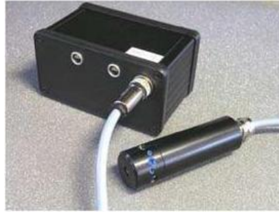
Şekil 3.3. ARCOptix ürünü bir yer değişim sensörü (13).
