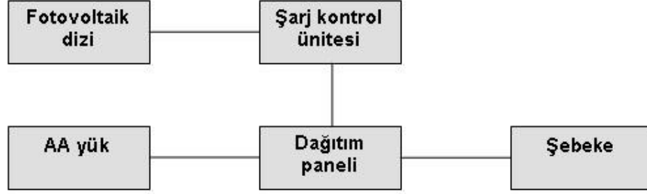
Şekil 2.16. Şebeke bağlantılı fotovoltaik sistem (19) .
