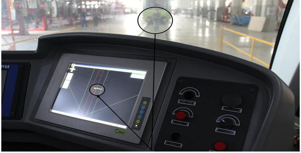
Şekil 4.8. Test aracına doğru 11 km/s hızla koşan yaya.
