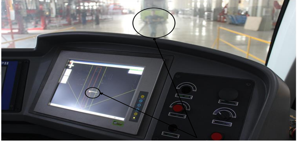
Şekil 4.9. Test aracına doğru 14 km/s hızla koşan yaya.
