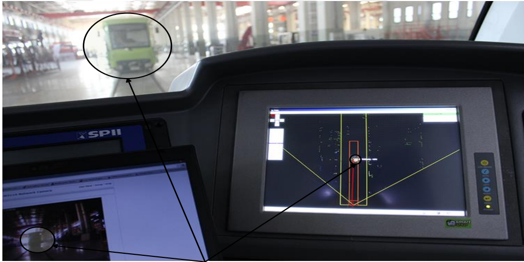
Şekil 4.5. Test aracıyla aynı hatta bulunan ve test aracına doğru 20 km/s hızla yaklaşan başka bir HRA.
