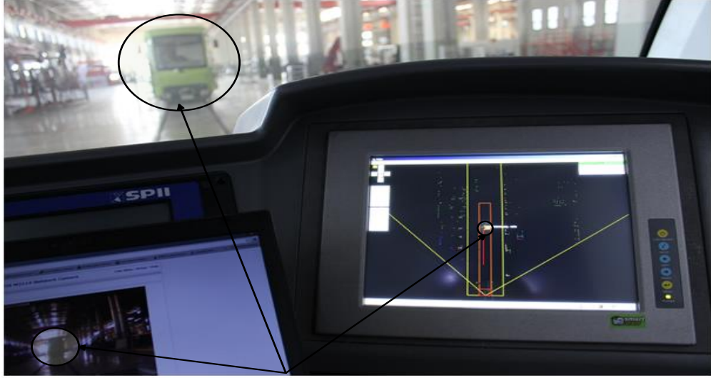
Şekil 4.4. Test aracıyla aynı hatta bulunan, 10 km/s hızla test aracına yaklaşmakta olan ve tehlike bölgesine girmiş başka bir HRA.
