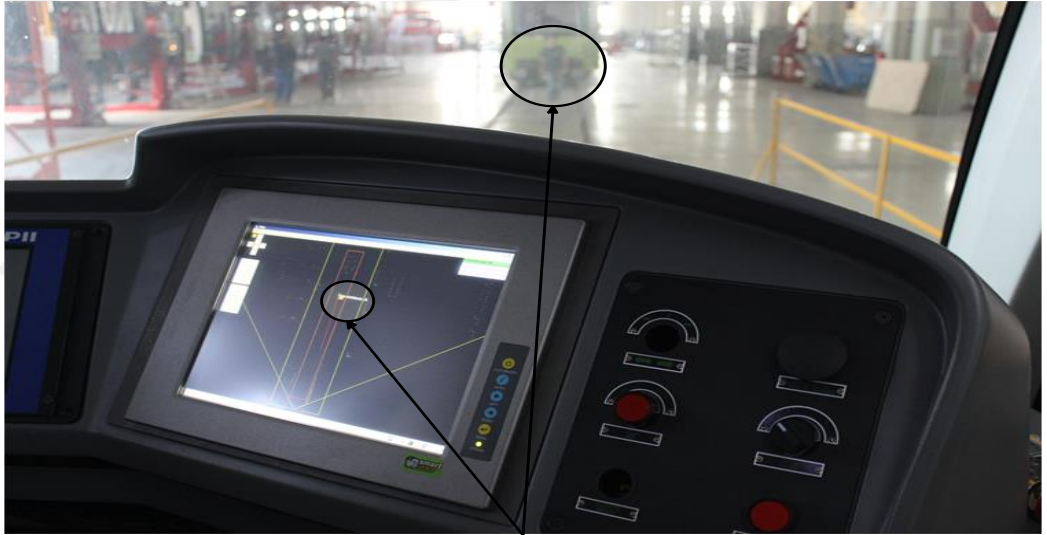
Şekil 4.7. Test aracına doğru 5 km/s hızla koşan yaya.
