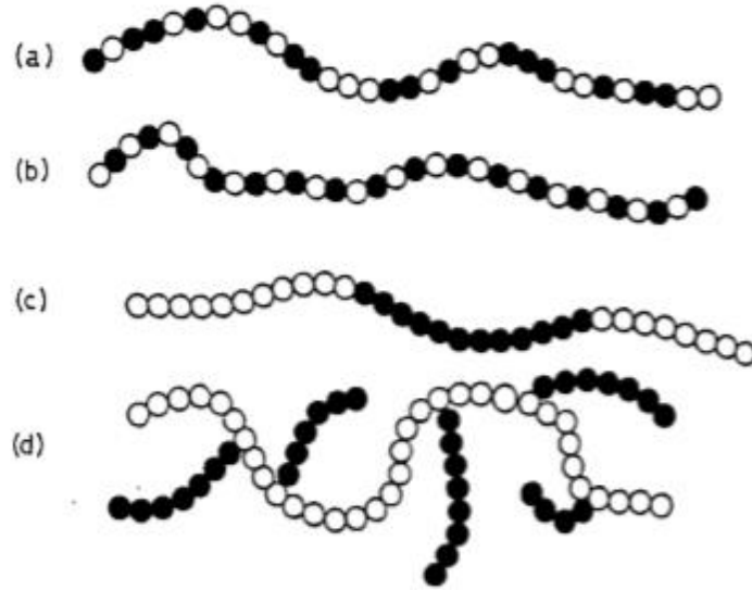
Şekil 1.2. Kopolimerlerin düzenlenmeleri: (a) rastgele kopolimer (b) ardışık kopolimer (c) blok kopolimer ve (d) aşırı kopolimer
