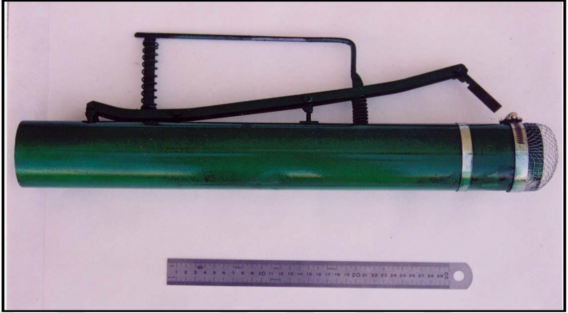
Şekil 2.2. Örneklerin yakalanmasında kullanılan canlı yakalama kapağı (Yağcı ve Aşan, 2007)
