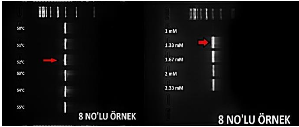
Şekil 3.23.RFLK08 kodlu izolatın PZR Optimizasyonu
