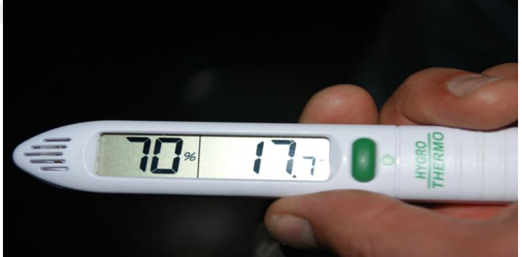
Şekil 3.15. Yarasa tünelerinin sıcaklık ve nemini ölçmek için kullanılan higrometre
