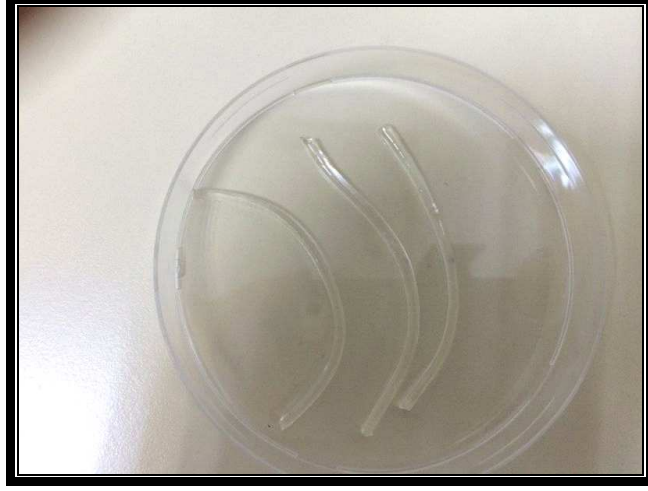
Şekil.3.1. Sentezlenen polimerin silindirlerden çıkarılmış jel hali
