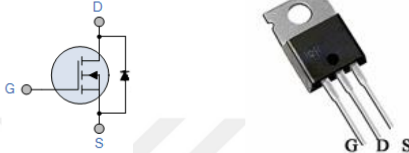
Şekil 6.2. N kanallı MOSFET sembolü ve pin yapısı
