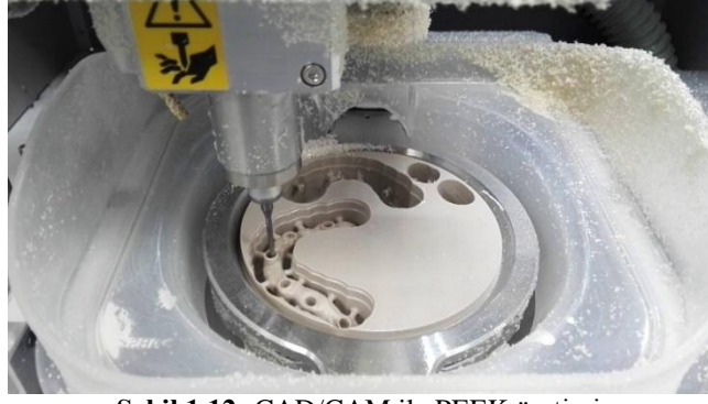
Şekil 1.12: CAD/CAM ile PEEK üretimi
