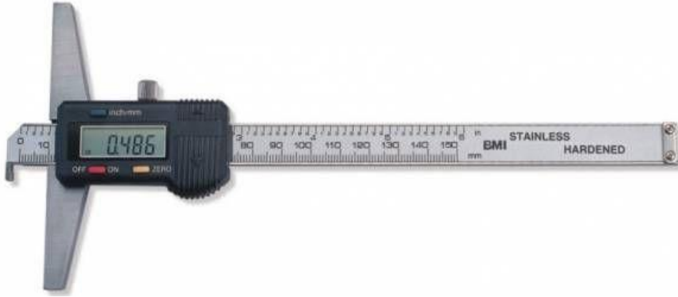
Şekil 2.9. Braketlerin yüzey alanlarının ölçülmesinde kullanılan kumpas
