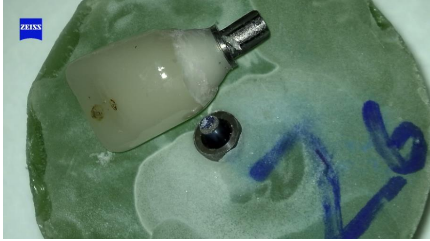
Şekil 3.5: Skor 3 (Kron ve dayanak hariç, vida kırığı ve dayanak implant bağlantı bölgesinde plastik deformasyon)
