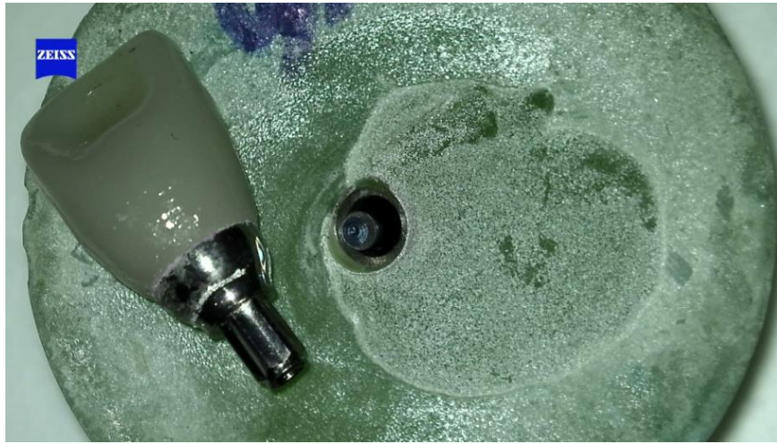
Şekil 3.2: Skor 3 (Kron ve dayanak hariç, vida kırığı ve dayanak implant bağlantı bölgesinde plastik deformasyon)
