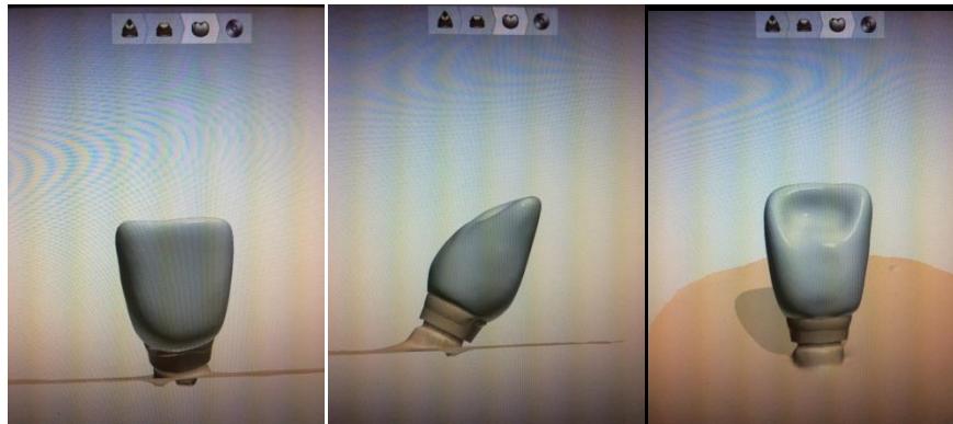
Şekil 2.14: Titanyum estetik implant dayanağı üzerine tasarlanan kron restorasyon
