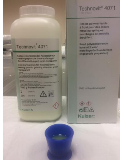
Şekil 2.7: Akrilik rezininin hazırlanması
