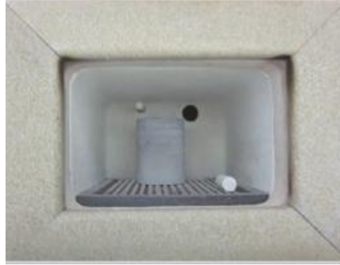
Şekil 1.7: Mufla ve presleme pistonu ön ısıtma fırınında
