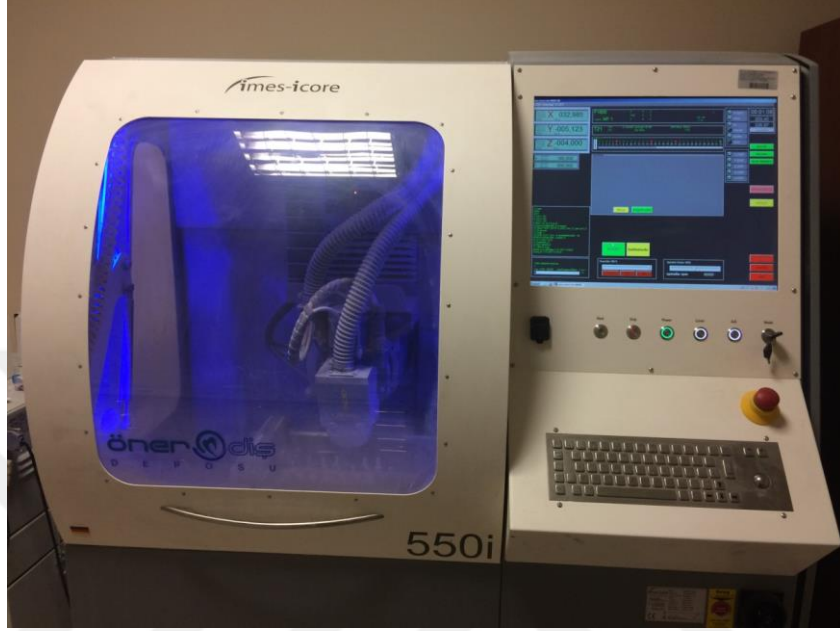
Şekil 2.19: Bilgisayar destekli üretim yapan cihaz (kazıma ünitesi) (imes icore CORITEC 550i)
