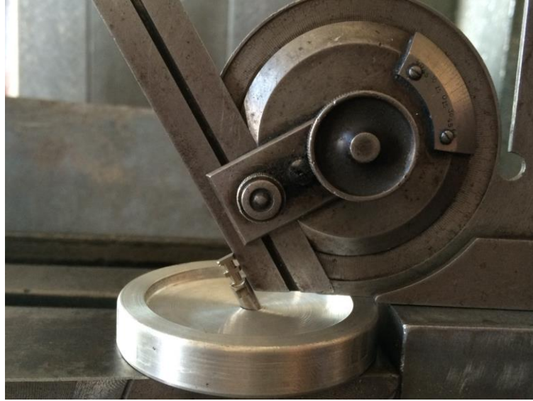
Şekil 2.6: Dayanak ve analog bağlantısının vertikal düzlemle yaptığı açının metal bir gönye ile kontrol edilmesi
