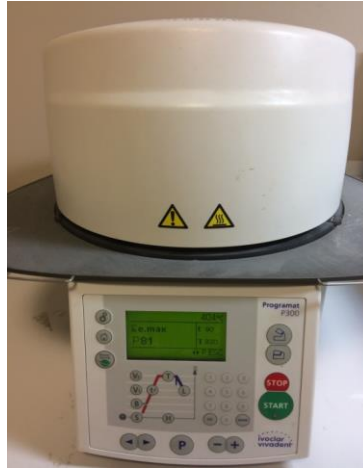
Şekil 2.20: Kristalizasyon ve glaze işleminin gerçekleştirildiği cihaz (Programat 300)
