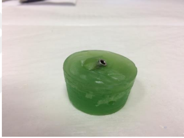
Şekil 2.9: Analogun gömülü olduğu rezin örnek
