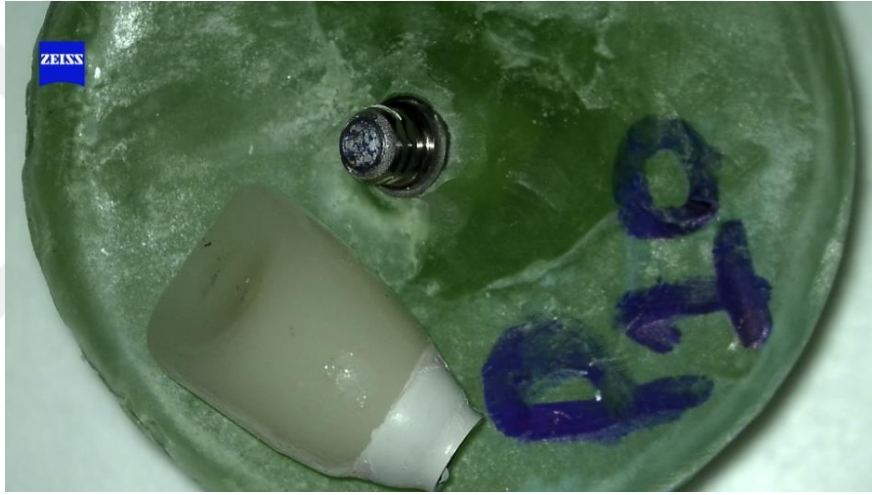
Şekil 3.10.: Skor 5 (Kron, dayanak ve vida kırığı olmaksızın titanyum altyapıdan dayanak kron birleşiminin ayrılması)
