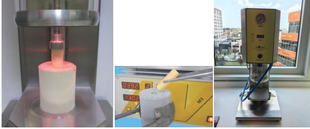
Şekil 1.8: Presleme pistonunu kullanılarak muflanın yüklenmesi ve vakumlu presleme cihazına yerleştirilmesi
