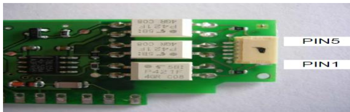
Şekil 3. 3. Lamba kontrol devresi pin atama [112]
