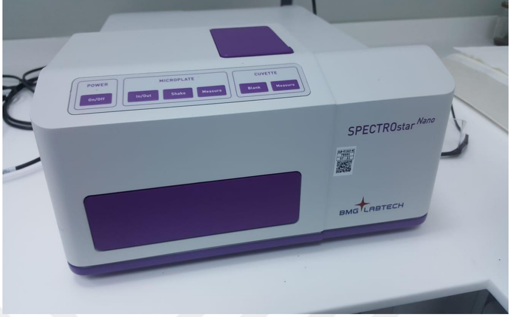
Şekil 2.5. Spectro star nano marka/model mikro plaka okuyucu
