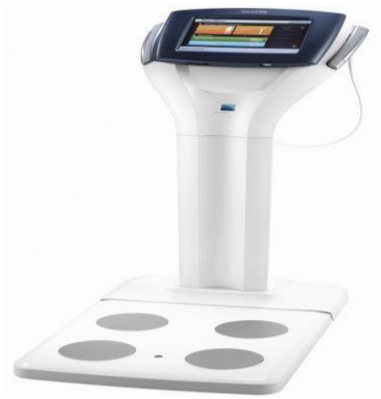
Şekil 3.2. Tanita MC-980 Vücut Ağırlığı Ölçüm Aleti
