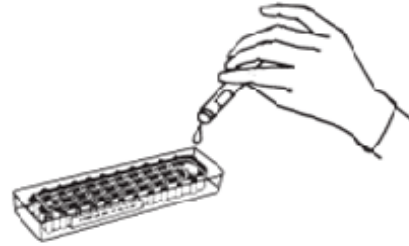
Şekil 2.1. Süspansiyonun hedef baz alanına dökülmesi
