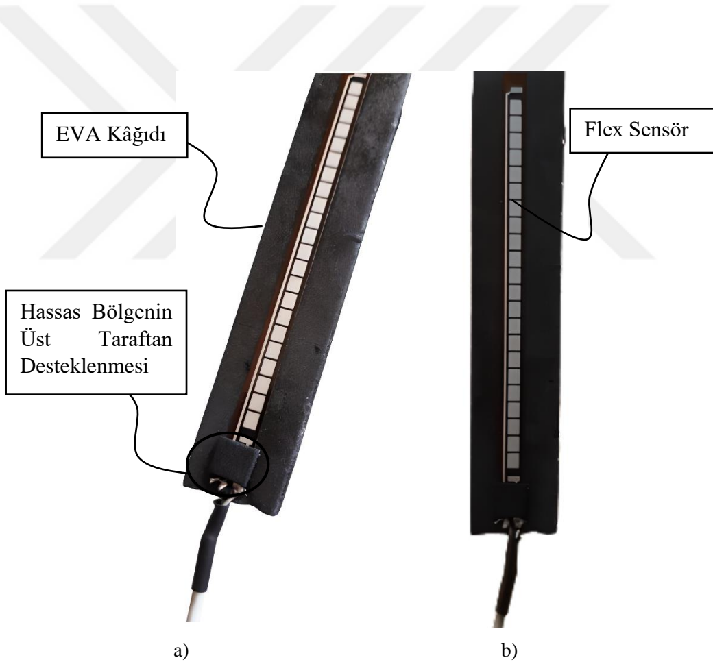
Şekil 3.20 Desteklenen flex sensör
