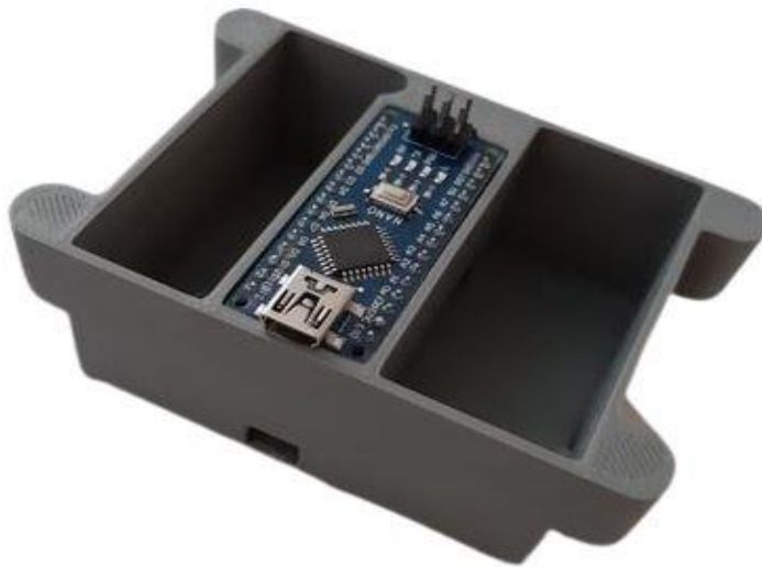
Şekil 3.11 Baskı sonrası kutu ve Arduino Nano
