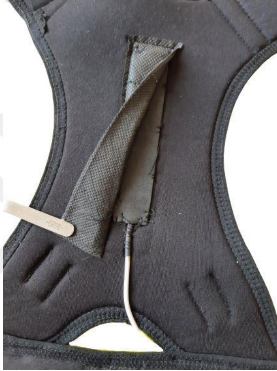
Şekil 3.21 Korse üzerine dikilen flex sensör
