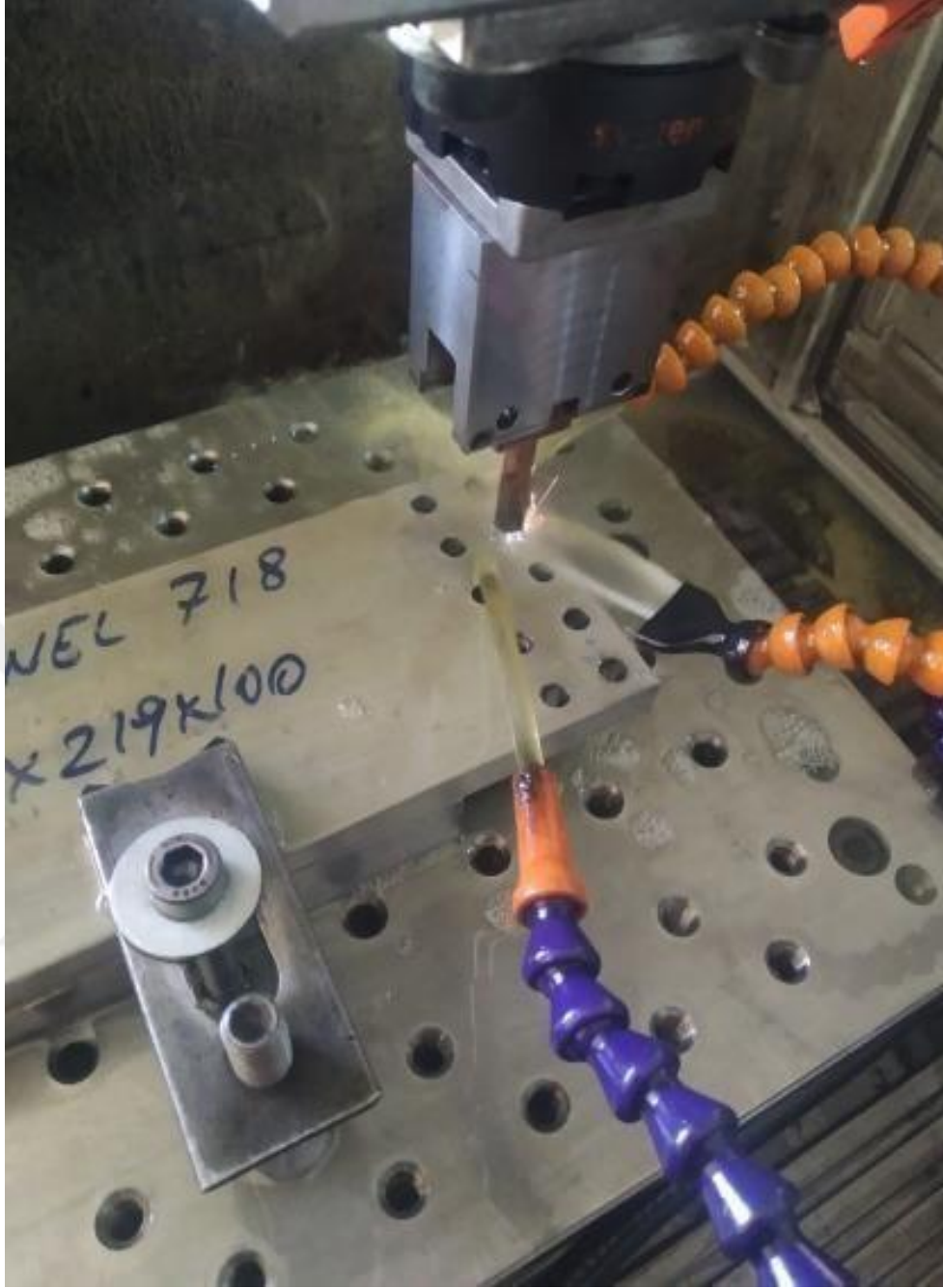
Şekil 2.4. Inconel 718 malzemenin dalma erozyon ile delik delme işlemi
