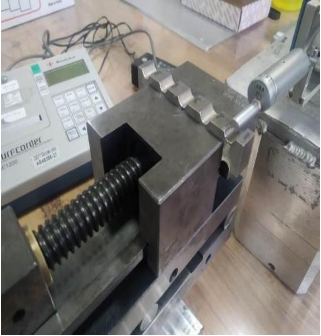
Şekil 1.5. Inconel 718 malzemenin yüzey pürüzlülüğü ölçümü
