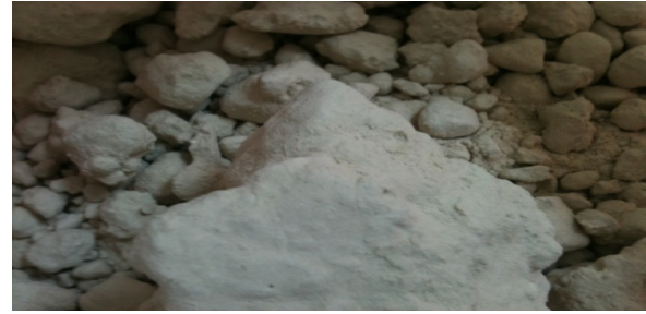
Şekil 4. Kalsinasyon işlemi öncesinde fosfojips (Before calcining phosphogypsum)
