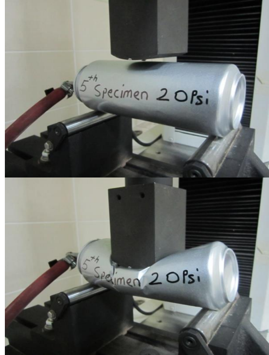
Şekil 3. Üç noktadan uygulanan eğme deneyi
