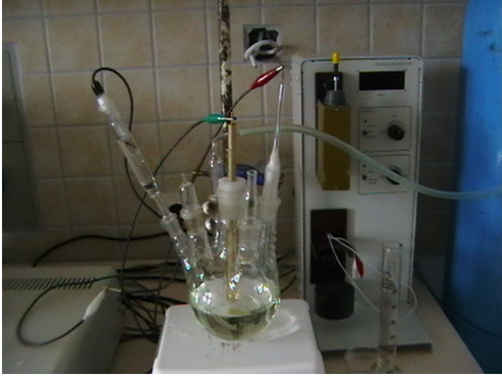
Şekil 3.2. Korozyon Hücresinin Fotoğrafl
