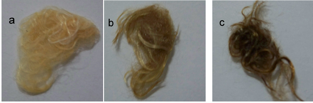
Şekil 3.30. Peroksidaz immobilize edilmiş PET lif (a), bir kez kullanılmış PET lif (b), yirmi kez kullanılmış PET lif (c)
