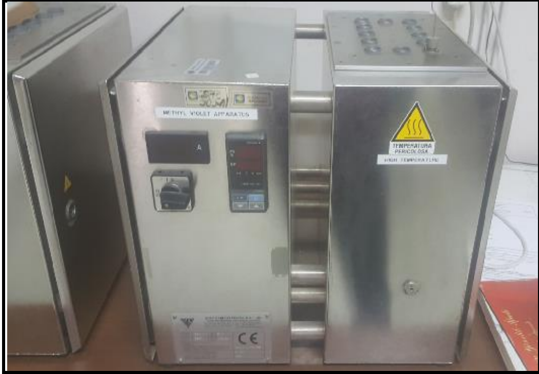
Şekil 2.4. Metil Viyole Kararlılık Test Cihazı (MKE Barutsan)
