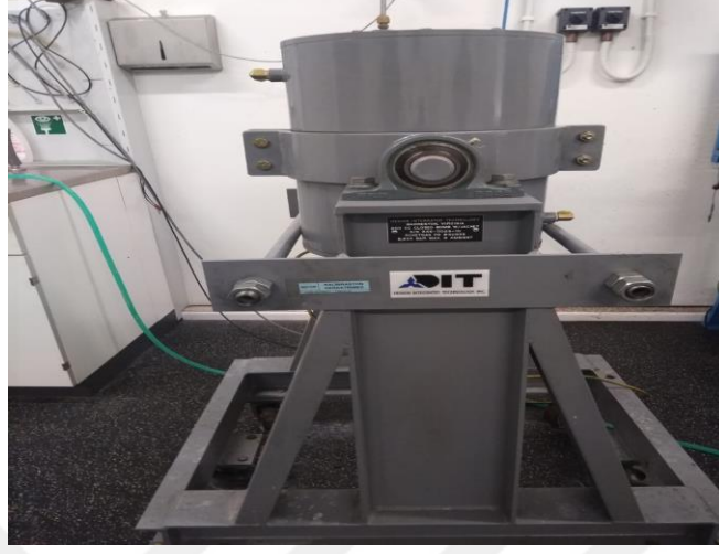
Şekil 2.46. Kapalı bomba katı yakıt yanma hızı ölçüm cihazı kapalı bomba kısmı
