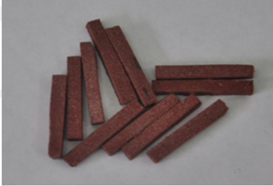
Şekil 2.19. AP / HTPB oksitleyici ve bağlayıcı yapılı kompozit yakıt numuneleri [34]
