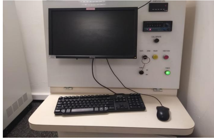
Şekil 2.47. Kapalı bomba katı yakıt yanma hızı ölçüm cihazı kontrol kısmı
