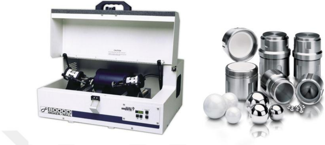
Şekil 1.3. Yüksek Enerji Çarpımlı Öğütücü, bilye ve kapları (Anonim 3)
