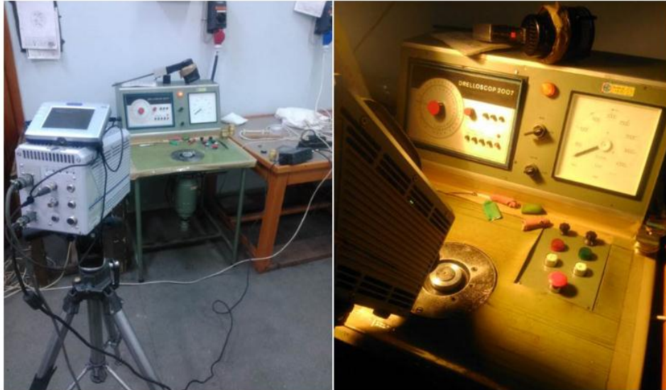
Şekil 3.18. Hızlı kamera yardımıyla sürenin belirlenmesi
