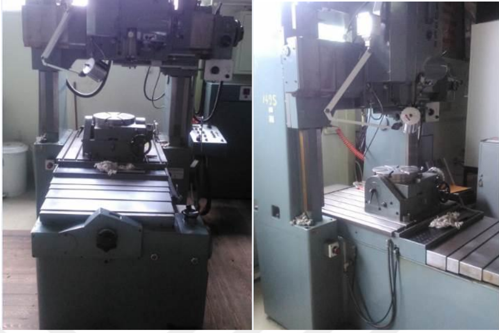
Şekil 3.14. Rotor ağırlıklarında deęişikliklerin yapıldığı koordinat tezgahı
