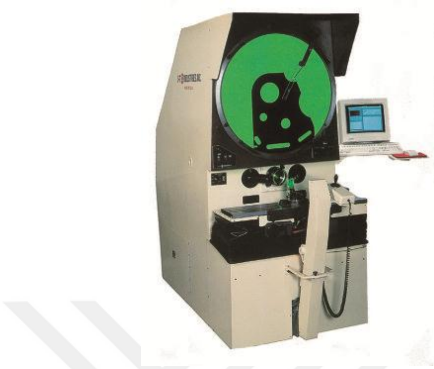
Şekil 3.16. Profil projeksiyon cihazı
