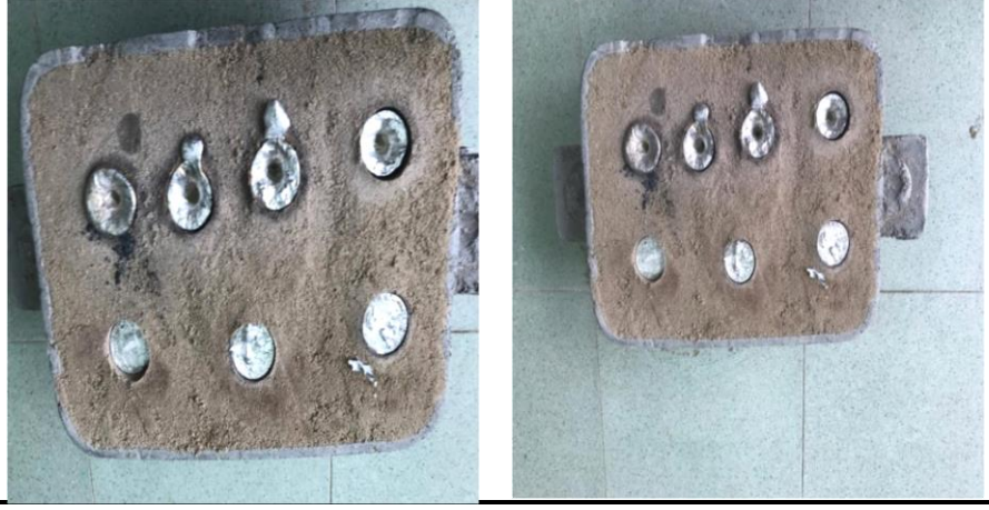
Şekil 4.5 MMK malzemelerin kum kalıp içerisinde bekletilmesi
