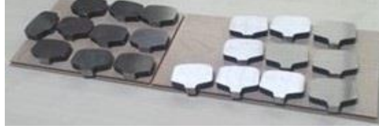
Şekil 3.8. Rayın mantar bölgesinden alınan numune örnekleri
