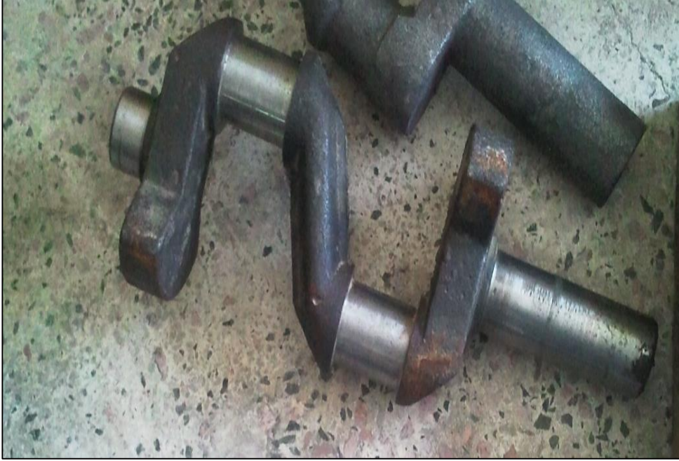
Şekil 3.4. Hassas İşleme Yapılmış Krank
