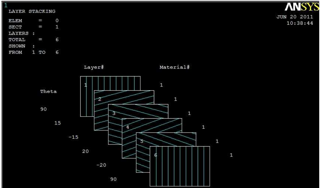
Şekil 4.5 Farklı açılarda sarılan elyaf katmanlarının Ansys® görüntüsü
