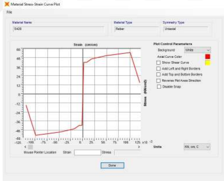
Şekil 4.7. S420 donatı için gerilme-şekildeğiştirme grafiği
