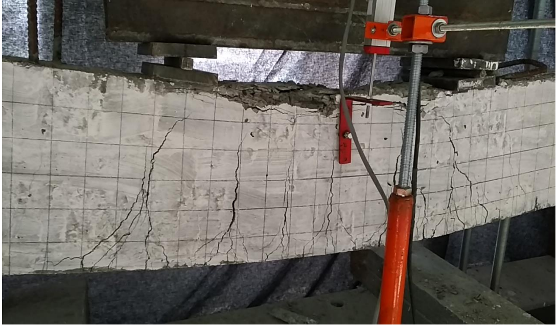
Sekil 2.28. HC2S3 (C8S12) Elemanı çatlak gelişimi
