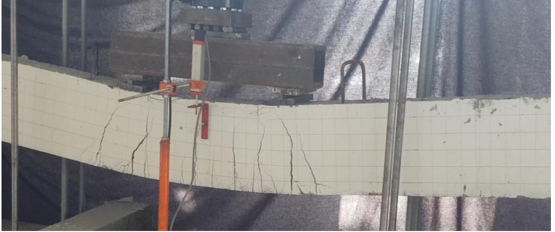
Sekil 2.13. NC2S3 (C6S12) Elemanı çatlak gelişimi
