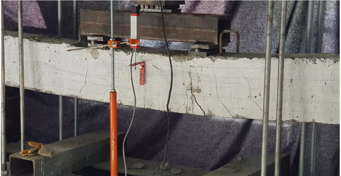
Sekil 2.25. HC3S2 (C8S10) Elemanı çatlak gelişimi
