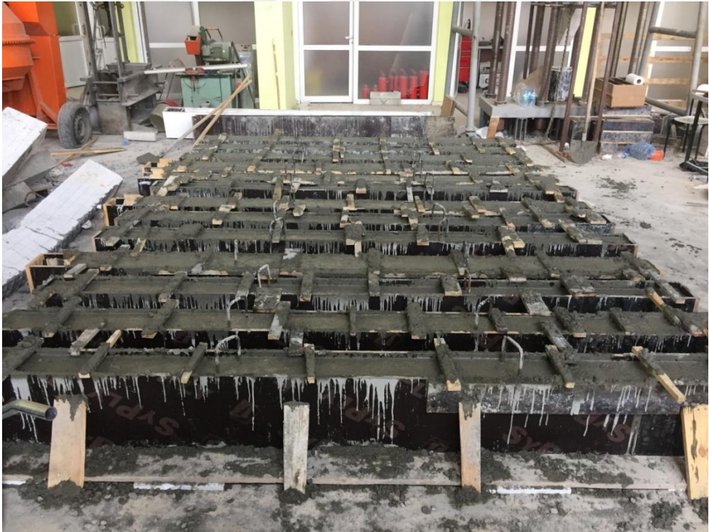
Şekil 2.9. Normal Dayanımlı Kirişlerin hazırlanması
