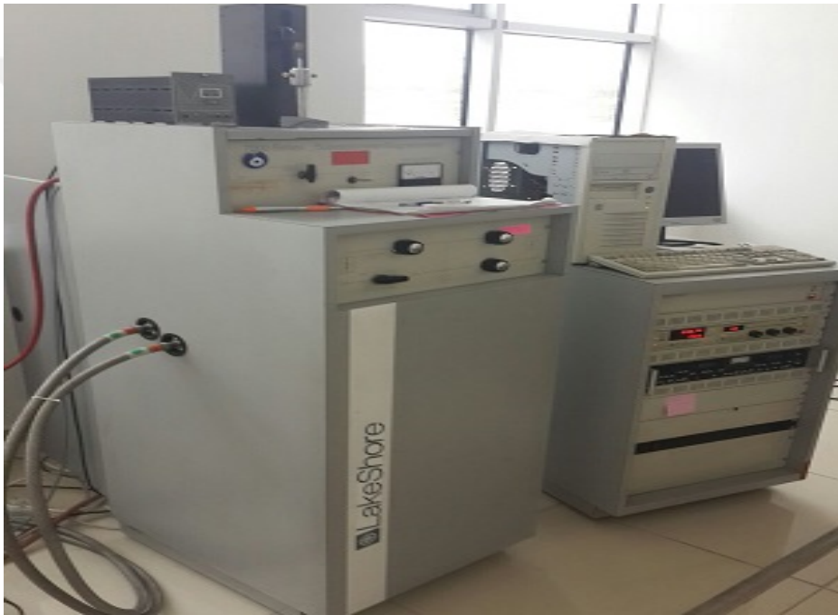
Şekil 3.6. AC Manyetik Alınganlık Ölçme Sistemi(Ankara Üniversitesi)
