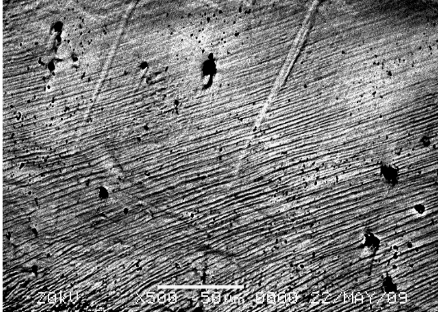
Şekil 3.20. %10 zorlanma sonrası austenite fazın SEM görüntüsü
