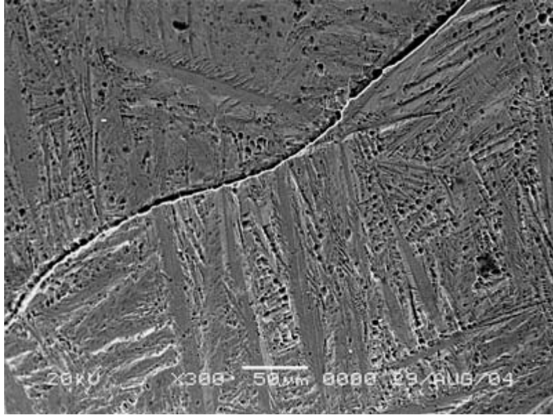
Şekil 3.1.5. 1100 °C sıcaklığında 45 saat ısıl işlem uygulanan alaşımda -196 °C' de austenite kristal yapı içerisinde oluşan martensite kristalleri.
