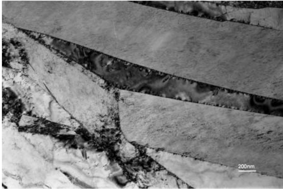
Şekil 3.2.1.a. 1100 °C' de 24 saat ısıtım görmüş alaşımda austenite ve martensite faza ait aydınlık alan görüntüsü (X30K).
